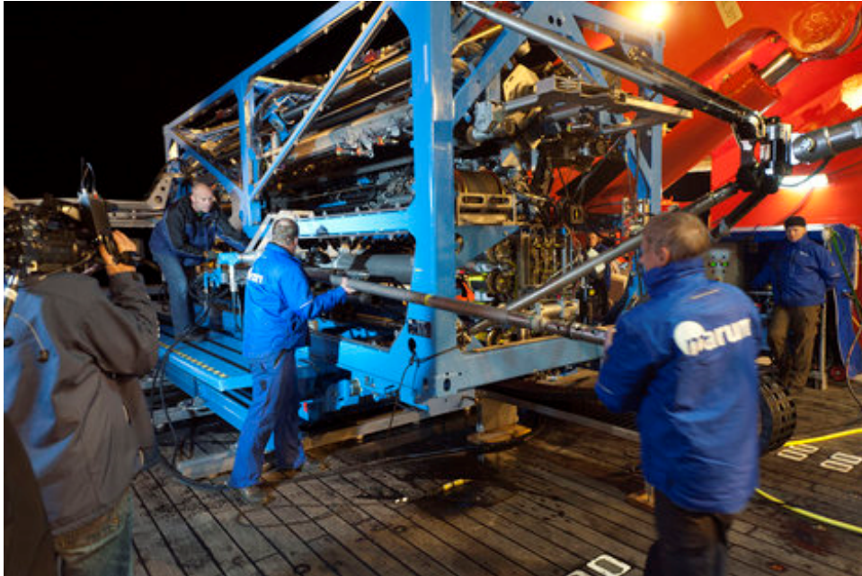
Abb. 2: Beladen der Magazine während der SONNE Testexpedition mit MARUM-MeBo200 im Oktober 2014 in der Nordsee. Das Ladesystem wird in den Rahmen des MeBo eingehängt, um die Kernrohre und Bohrstangen hydraulisch in die vorgesehenen Magazinfächer einzudrücken.
