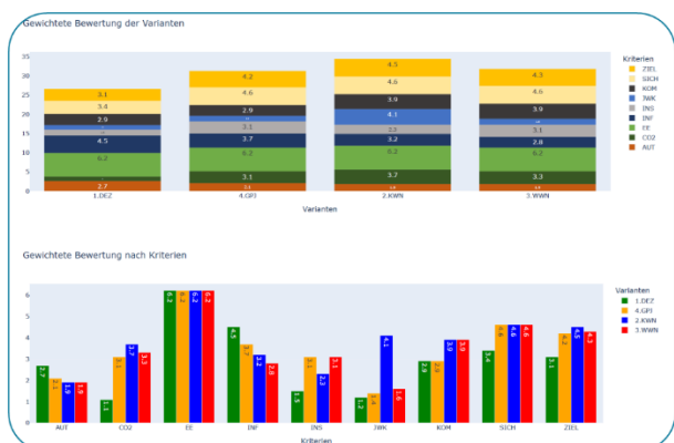
Abb. 5: Ausschnitt aus dem Bewertungstool mit Darstellung der gewichteten Gesamt- (oben) und Einzelkriterienbewertungen (unten) der vier Versorgungsvarianten zur Fokussierung der Stakeholderdiskussionen im Rahmen des Decision Workshops
